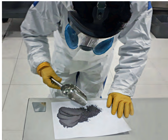
Homogenitätstest der Mischung im MAP-Testlabor in Wuxi/China Mixture homogeneity check at MAP test laboratory in Wuxi/China
