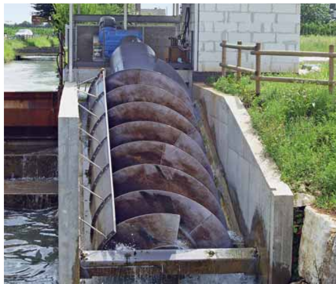
FIGURA 1 - Schema del funzionamento di un impianto micro-idroelettrico con coclea idraulica
