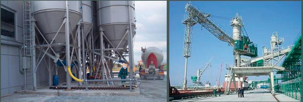
Fig. 2 - Sistemi di carico dei sili.
